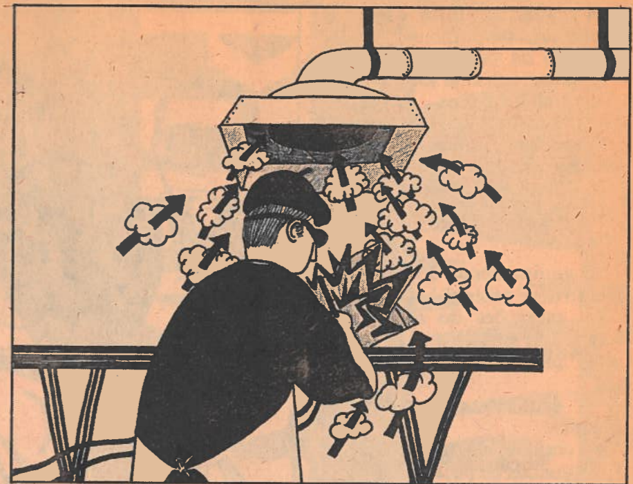
Equipar a cabina de soldadura de um dispositivo de extracção de fumos e gases...
