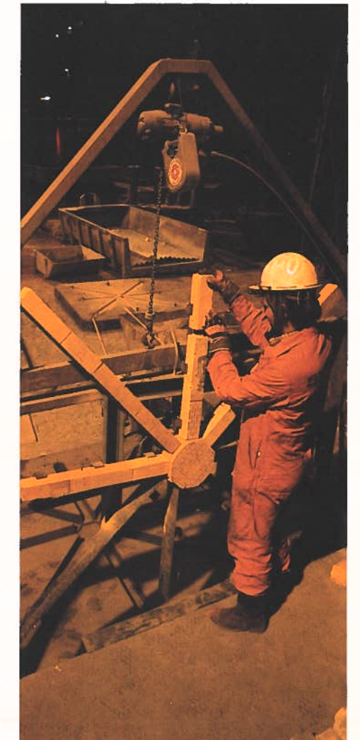
planläggarnas besvärliga arbetssituation. Vid SKF i Hällefors, har bl a en prototyp för själva läggingsarbetet konstruerats som avsevärt underlättar det arbetsmomentet. Med hjälp av iläggingsramen kan arbetet ske stående.
