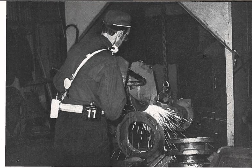
Une pièce en fonte d'acier est nettoyée par une machine à émouder au fuseau oscillatoire. L'exposition de l'ouvrier aux poussières est mesurée par un appareil portatif qui prélève des échantillons.
