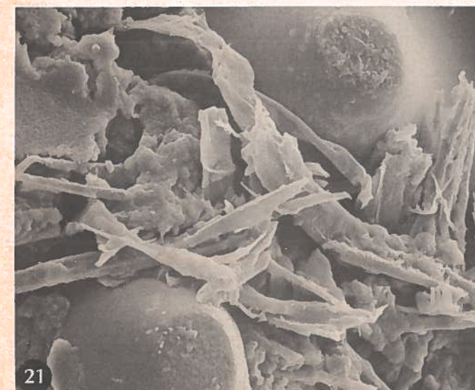
Figures 20 à 24: Plaques Nyloprint encrassées sur lesquelles on a fait disparaître l'encre; grossissement: 20 = 55 x, 21 et 22 = 150 x, 23 = 580 x, 24 = 1500 x.
