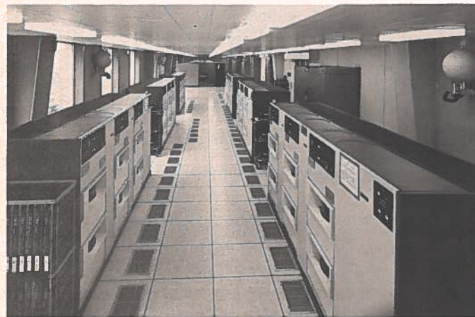
Figure 2: Salle des ordinateurs des NMPP à Paris avec mémoires à disques magnétiques au premier plan et unités centrales au fond (dans «techniques de presse» de juin 1976, page 1, on trouve une photo du pupitre de commande et de l'unité centrale d'une des deux installations d'informatique IBM 370/168 des NMPP).
