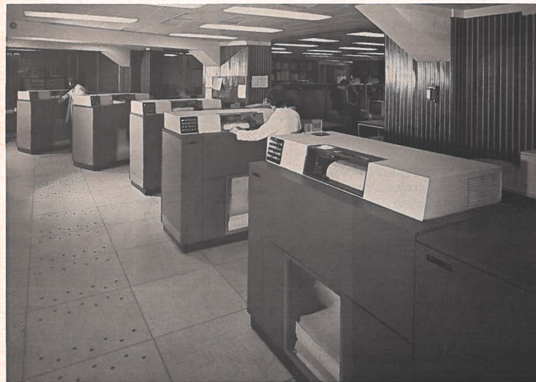
Figure 3: Salle des appareils périphériques (unités de bande magnétique et terminaux à écran) dans le centre d'informatique des NMPP.
