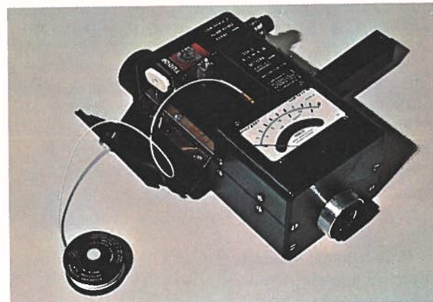
Bilden visar en universalljusmeter med den kabelanslutna mätcellen för luxmätning uttagen.
