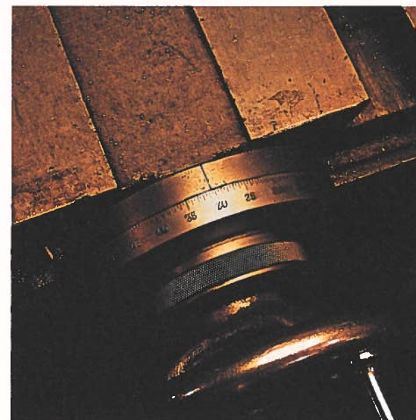
4. Det här är samma bild som den förra, men vi har sprayat den blanka rattan med matt klarplastlack. Denna klarplast tål stötar och slag bra. När plasten blir nedsliten är det bara att tvätta bort den med acetone och spraya på nytt. Säkert kan många blanka, reflekterande små ytor mattas ner på det här sättet.
