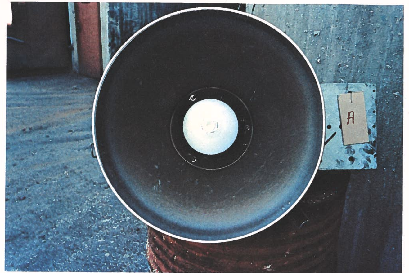
Så här kan en reflektor se ut efter att ha brunnit 7 000 timmar i ett gjuteri. Mycket lite ljus reflekteras och reflektorytan av aluminium är svår att rengöra.
