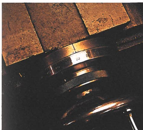
3. Med lysrören inkopplade förändras läget. Trots att skalan är blank syns skalstreck och siffror tydligt.
