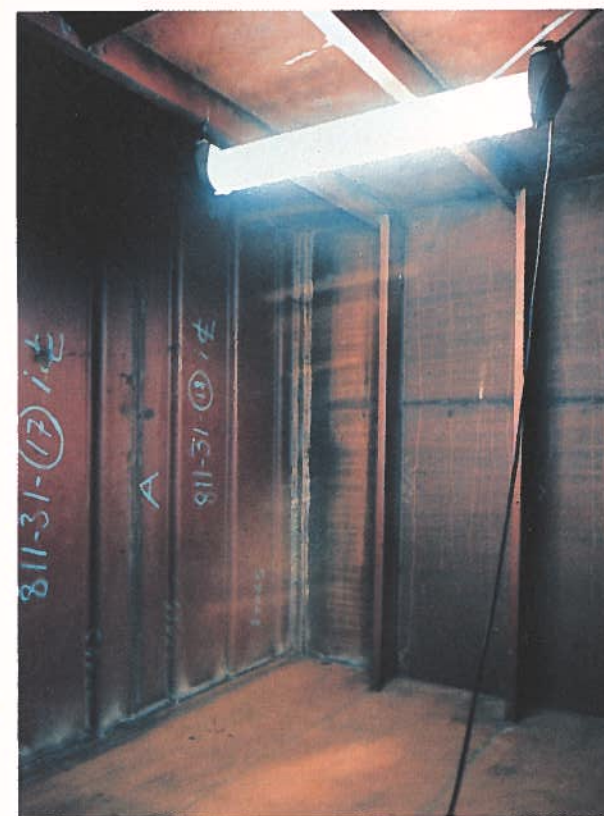
Det här är ett utrymme i ett tankfartyg som dels målats med traditionell brunröd rostskyddsfärg, dels med en ny gul färg med samma rostskyddande egenskaper. Belysningen är densamma. Den ljusa färgen
