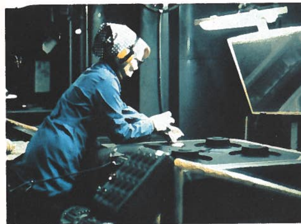
Här är en bild från ett gjuteri. Bländningen blir så stark att den anställde har direkt svårt att se. Hur löser man problemet? Om man höjer armaturen och förser den med bländskydd minskar problemen. Men ännu bättre är att placera platsbelysning så att ljuset faller in snett bakifrån. För de flesta synuppgifterna är det den bästa ljusriktningen.
