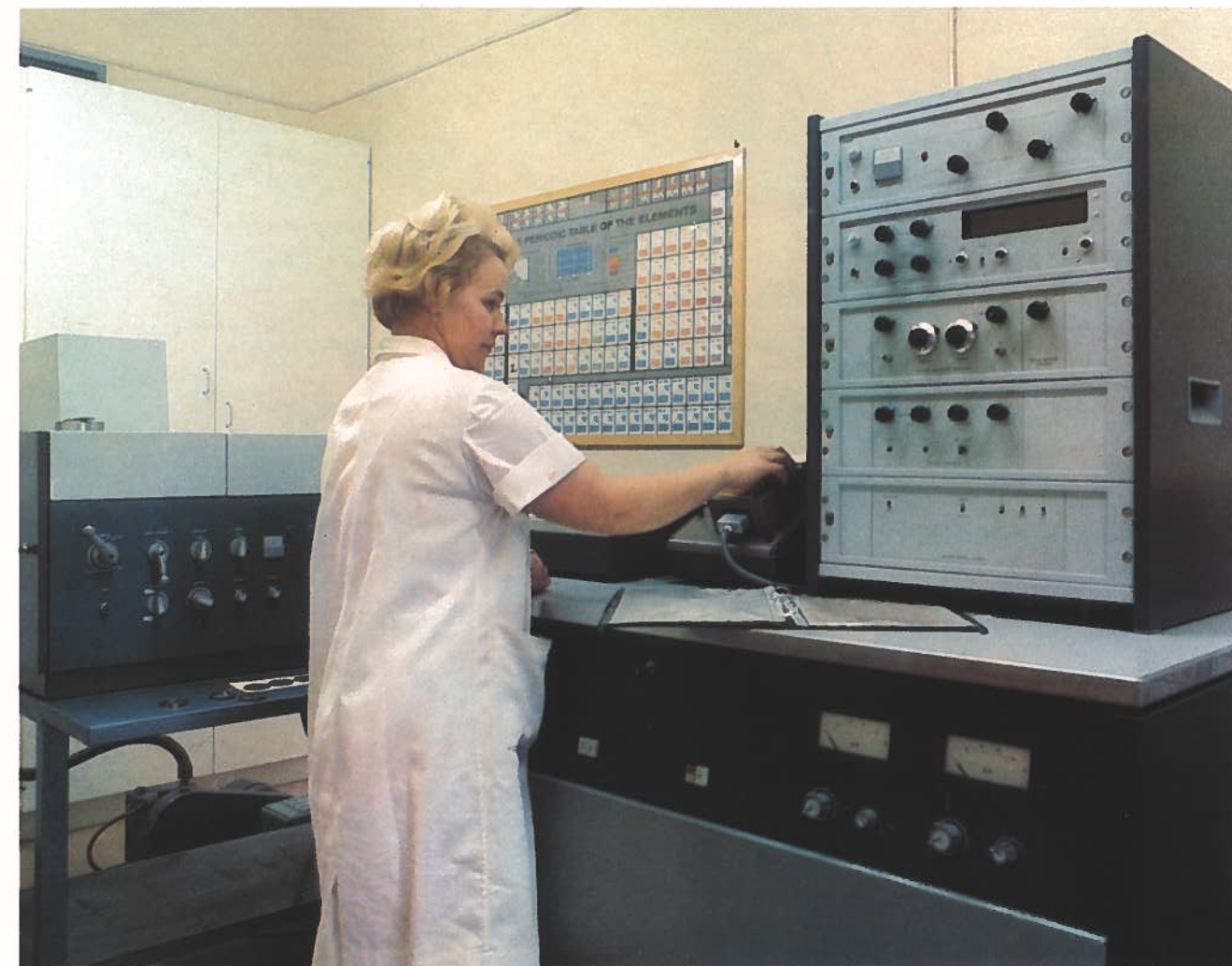
Le spectrophotomètre rapide Philips PW 1410 rayons X est utilisé à Turku pour analyser la fonte.
