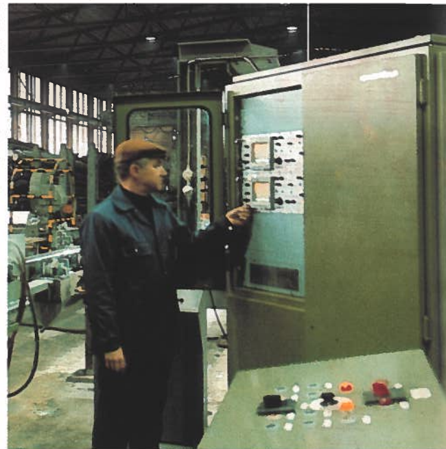
Les défauts sont détectés par essai aux ultrasons, marqués à la peinture et ensuite enlevés.
