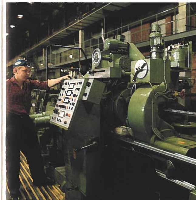
La capacité de production des barres recuites est en accroissement continu, au fur et à mesure de l'installation de nouvelles unités d'usinage. Les photos représentent une machine à écrouter Calow à grande capacité.
