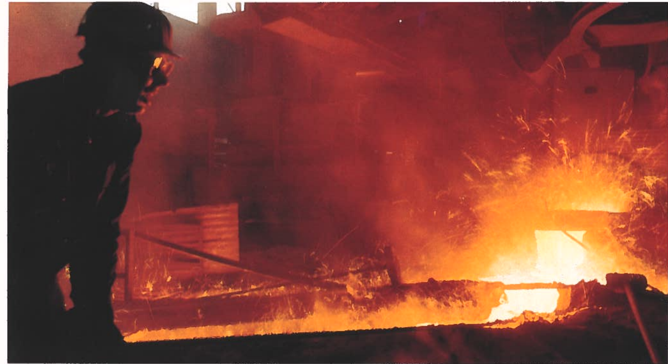
La coulée continue dans laquelle la fonte se solidifie en gueuses (partie inférieure).
