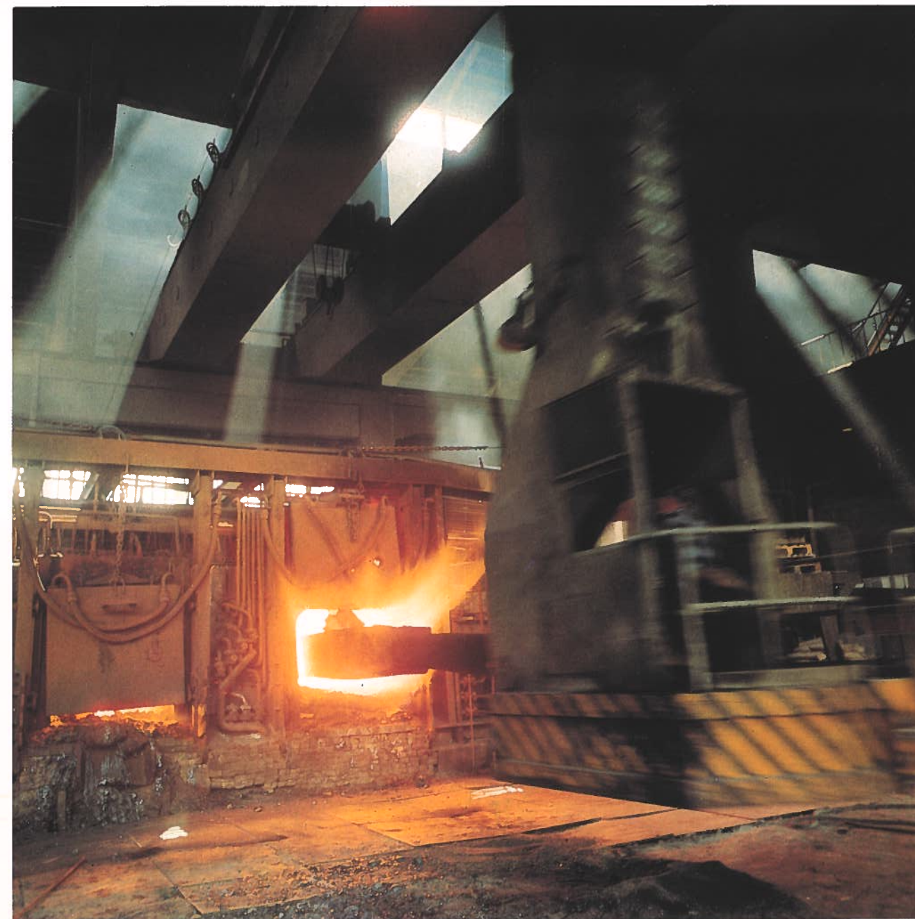
Le four Martin est chargé de mitraille et de fonte.
