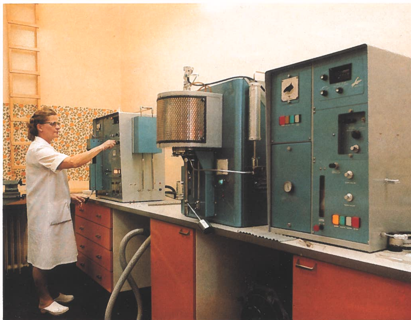
Le laboratoire chimique à Imatra fait usage de doseurs d'oxygène et d'azote de fabrication Leco.
